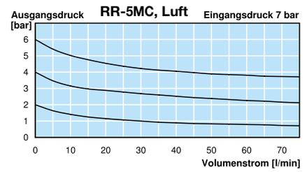
\*1 bei Druckluft 7 bar Eingangsdruck, 6 bar Ausgangsdruck und 2 bar Druckabfall bei Wasser Eingangsdruck 2 bar über dem Ausgangsdruck
